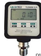
LR-Cal TLDMM-3.0: Carcasa giratoria 90°, grado de protección IP 67.
